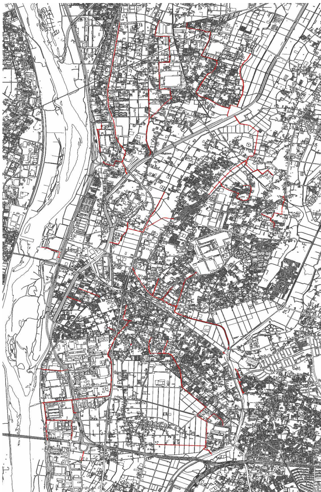
図 16 雨水管の布設位置
