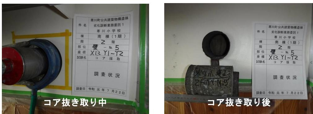
本庁舎は、国土交通省の「大規模リニューアル導入ガイドライン」や、文部科学省「学校施設の長寿命化の手引き」などに示された調査手法を採用してコンクリート造建物の壁（＝コア）を抜き、「強度」と「中性化の進み具合」から「躯体の健全度」を図るものです。
