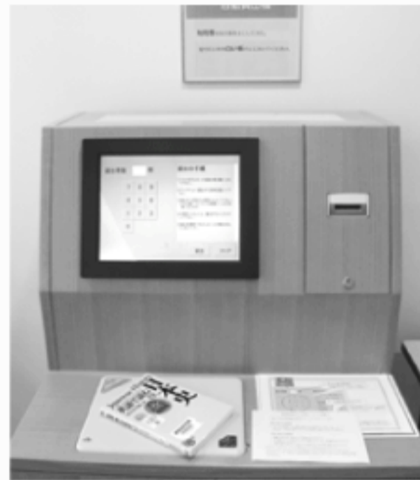
自動貸出機 画面下の白いプレートがICタグを読み取るセンサーになっています
