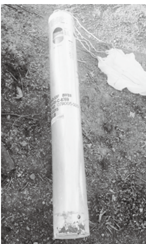
落下した機材は金属製で直径約12センチメートル、長さ約90センチメートルの浮標(水中音波探知機内蔵)でした。
