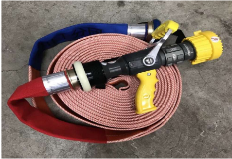
町消防団に配備した50mmホースとガンタイプノズル
