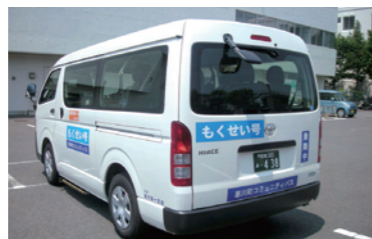
○全長4840mm、幅1880mm、高さ2105mmの小型車両。 ○乗車定員8名。
