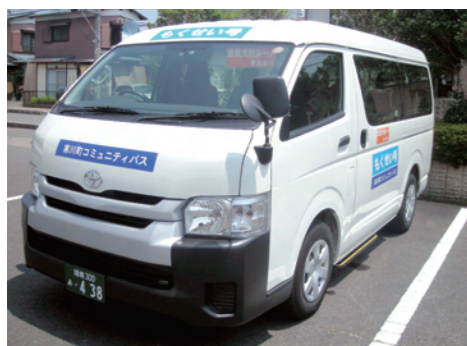
○全長4840mm、幅1880mm、高さ2105mmの小型車両。 ○乗車定員8名。
