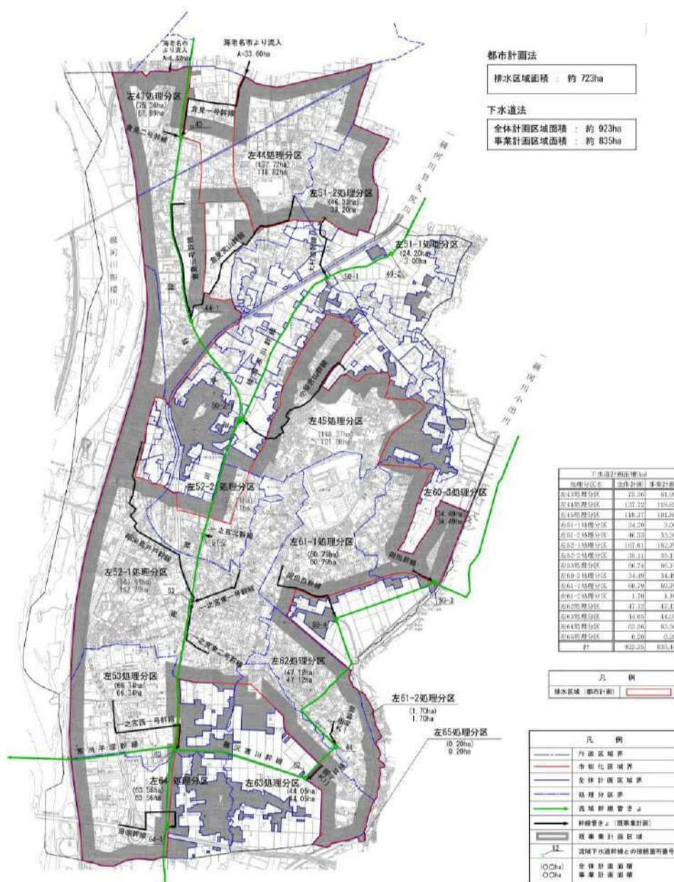
図 5-34 寒川町公共下水道計画一般図 (汚水)
