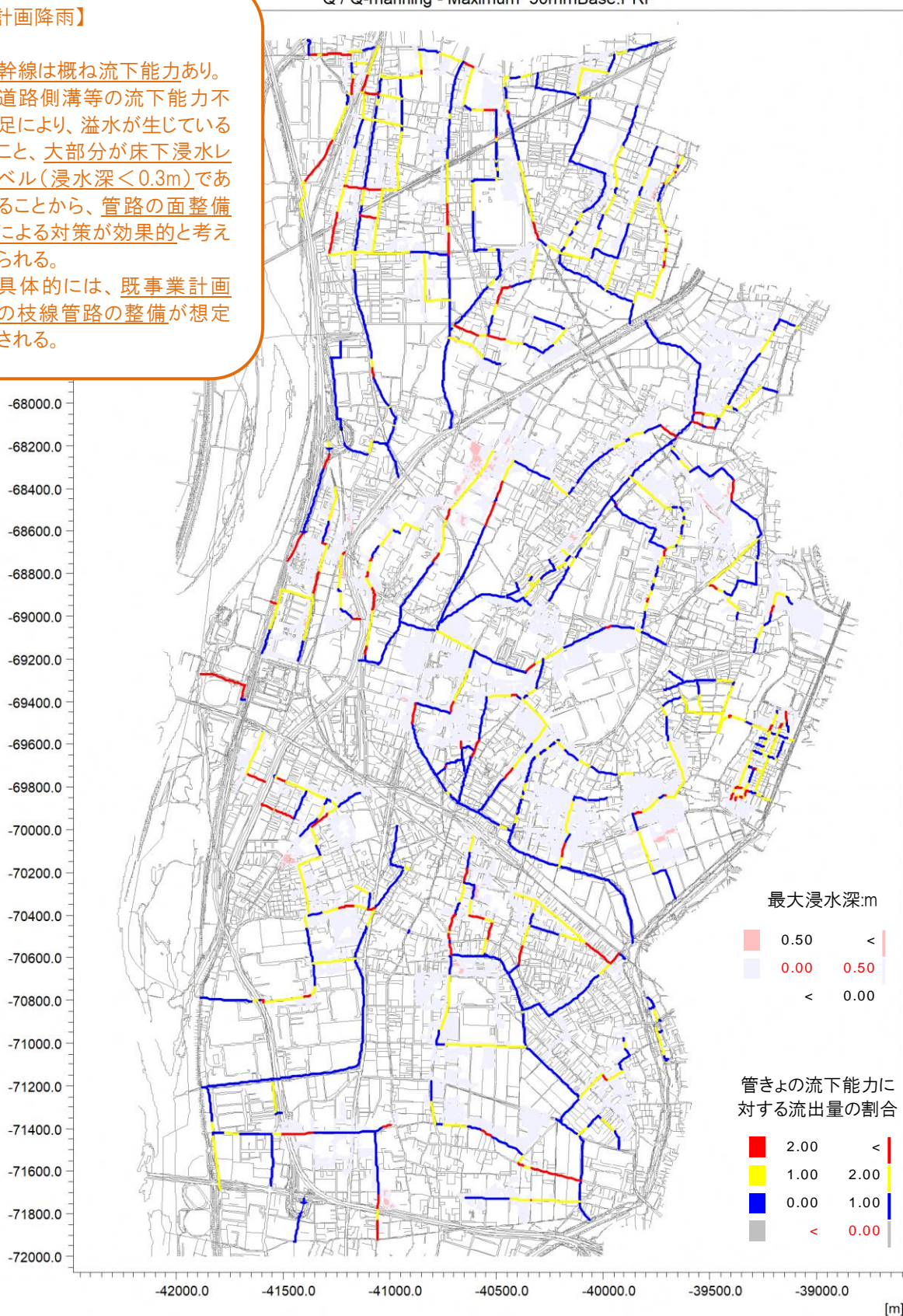
図 4.3 計画降雨時の管きよの流下能力に対する流出量の割合と最大浸水深
