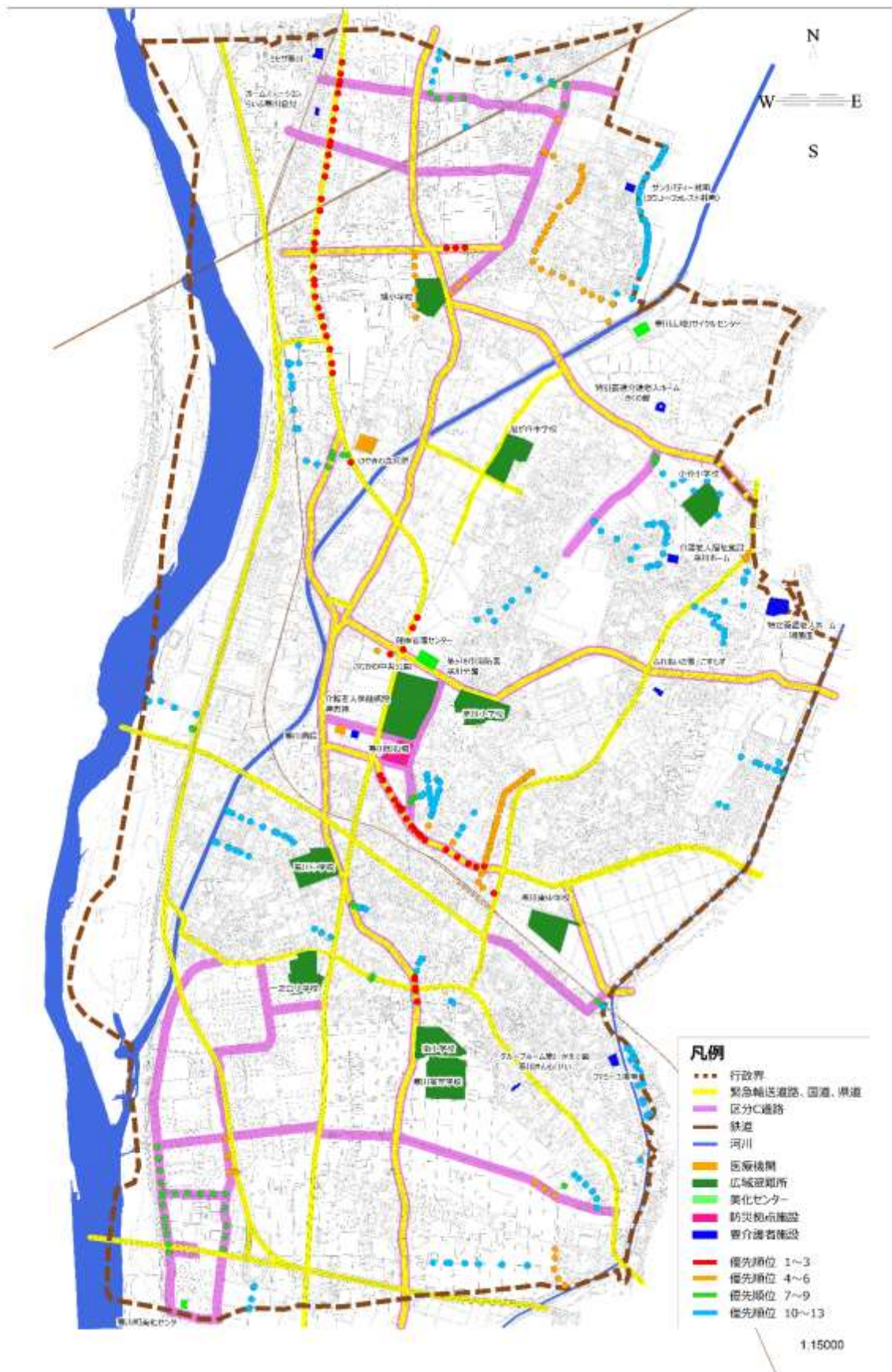
図 3-16 優先度 雨水マンホールふた
