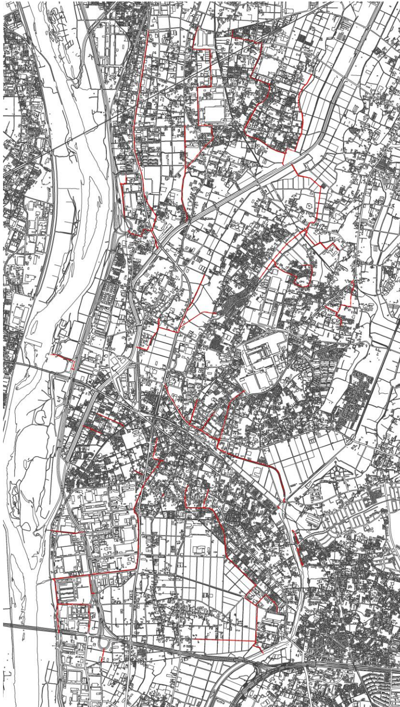
図 5.10 雨水管の布設位置
