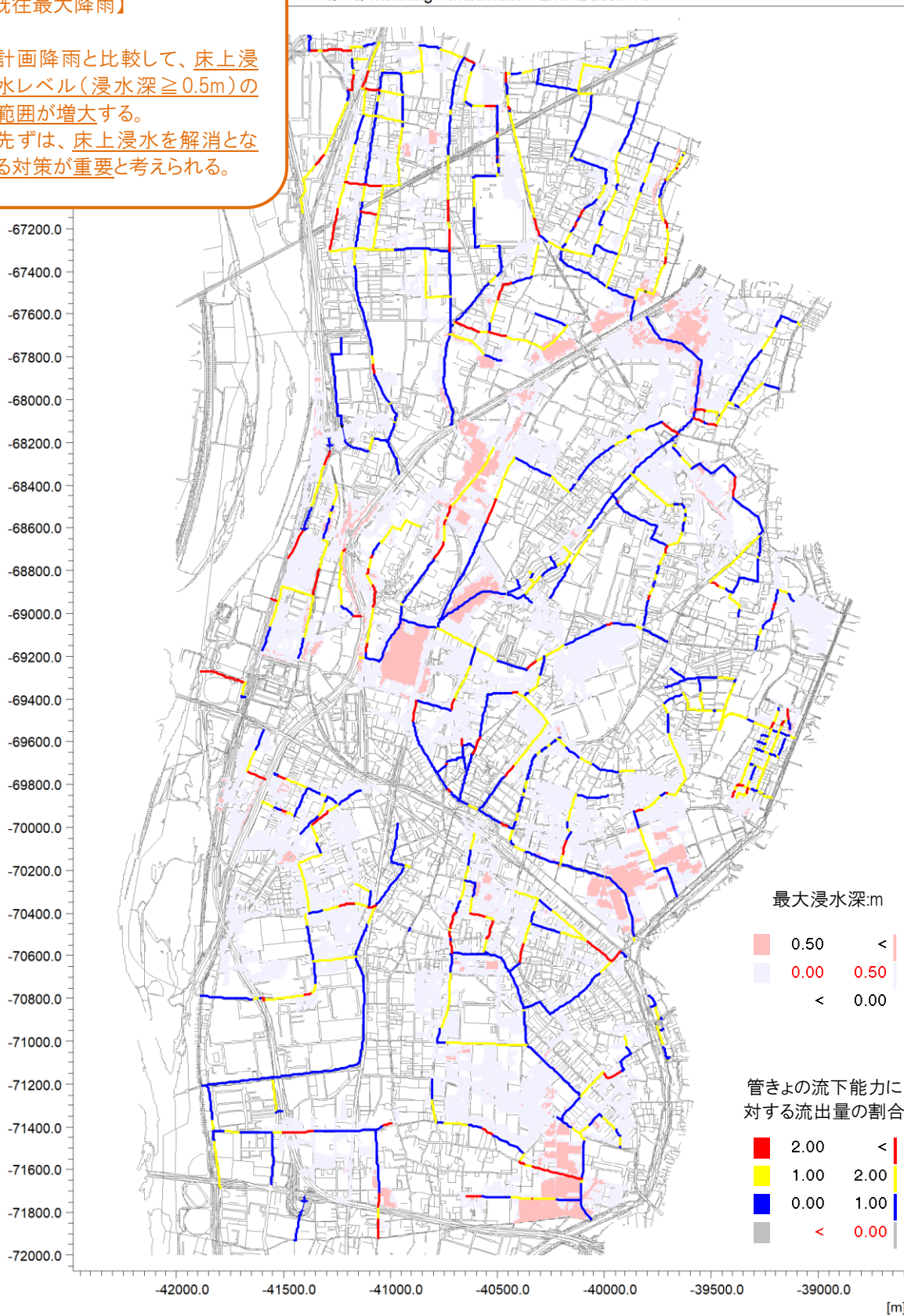
図 4.4 既往最大降雨時の管きよの流下能力に対する流出量の割合と最大浸水深
