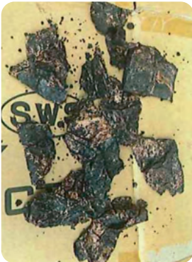
発火したリチウムイオン電池
