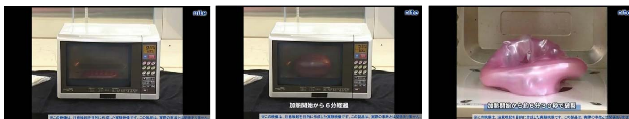
写真3 NITEによる電子レンジで温めるタイプのゆたんぽを加熱しすぎて破裂した事故の再現映像
